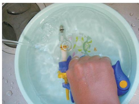
3) 注射器のメンテナンス 2 注射器の乾燥 バレル（目盛のついた透明プラスティック製の筒）を注射器本体からねじって外します。バレルと、握り+ピストンを水道水ですすぎ、内部に残った水を振り出してから別々に乾燥させます。
