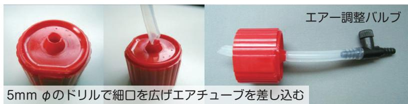
きます。マヨネーズ容器の場合は、星形の内栓を外し、パチンと閉まるヒンジキャップも切り取って、細口を 5mm φ のドリルで広げ、5~6cm に切った短い連結ホース(エアチューブ)を差し込んで使います。エアチューブの末端に、熱帯魚店で販売されているプラスティック製のエアー調節バルブを取り付けておくと、連結ホースとのジョイントとして使える上に密栓もできて便利です。
