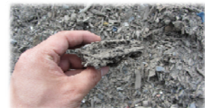
海水由来の固着性による団粒化
