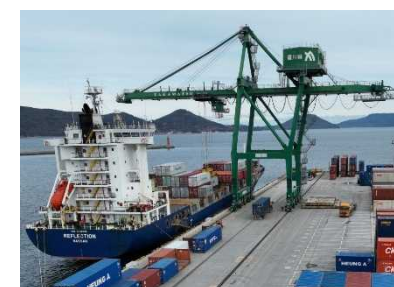
インバータ制御方式のガントリークレーン (平成25年度完成)
