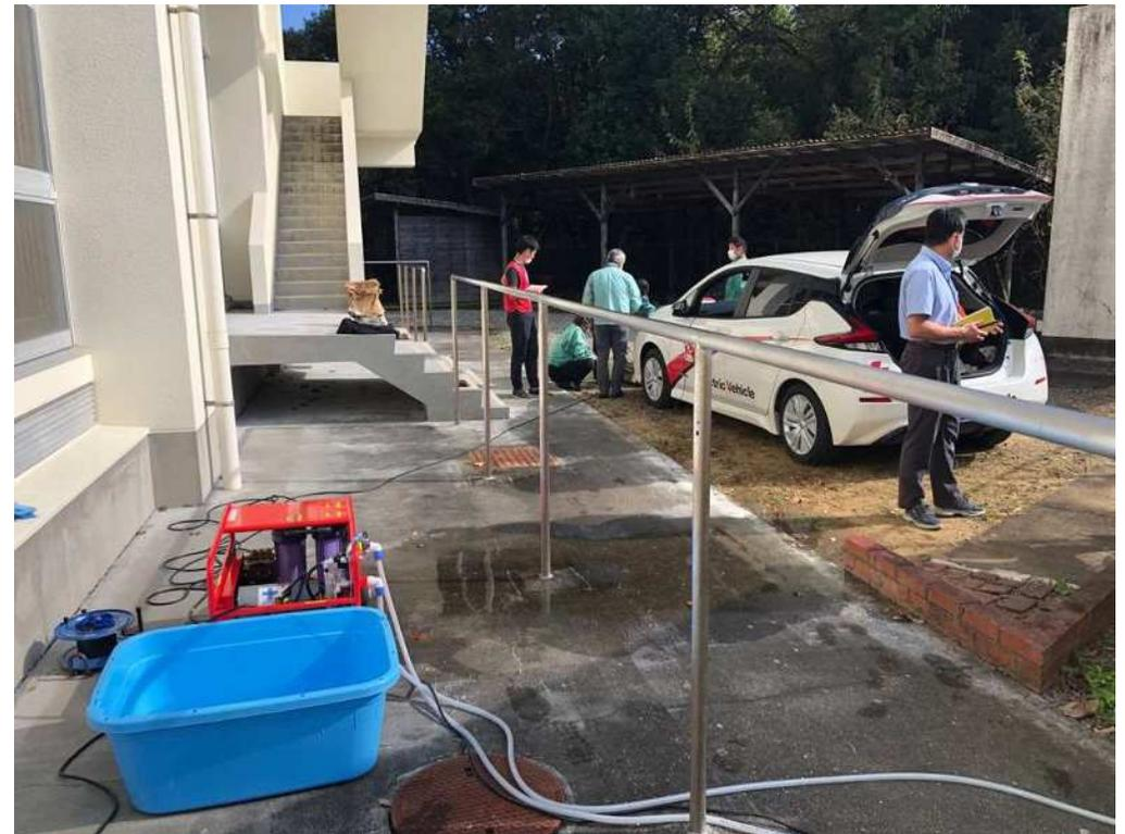
避難所となる体育館にEVを持ち込み、備蓄資機材の浄水器を稼働。プールの水を浄水して飲料水の提供
