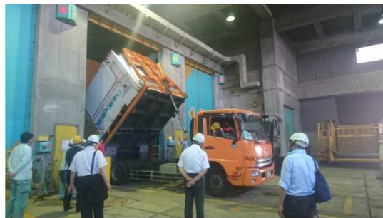
コンテナをダンプアップし、コンテナ後 妻側扉より災害廃棄物を排出
