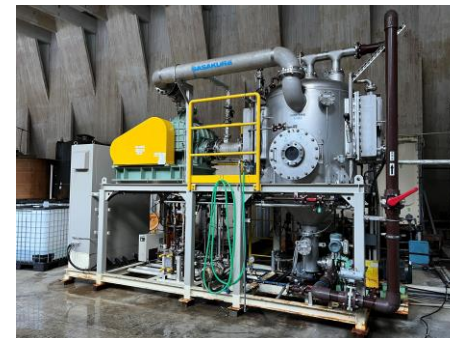
<ヒートポンプを採用した減圧濃縮装置>
