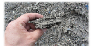
海水由来の固着性による団粒化
