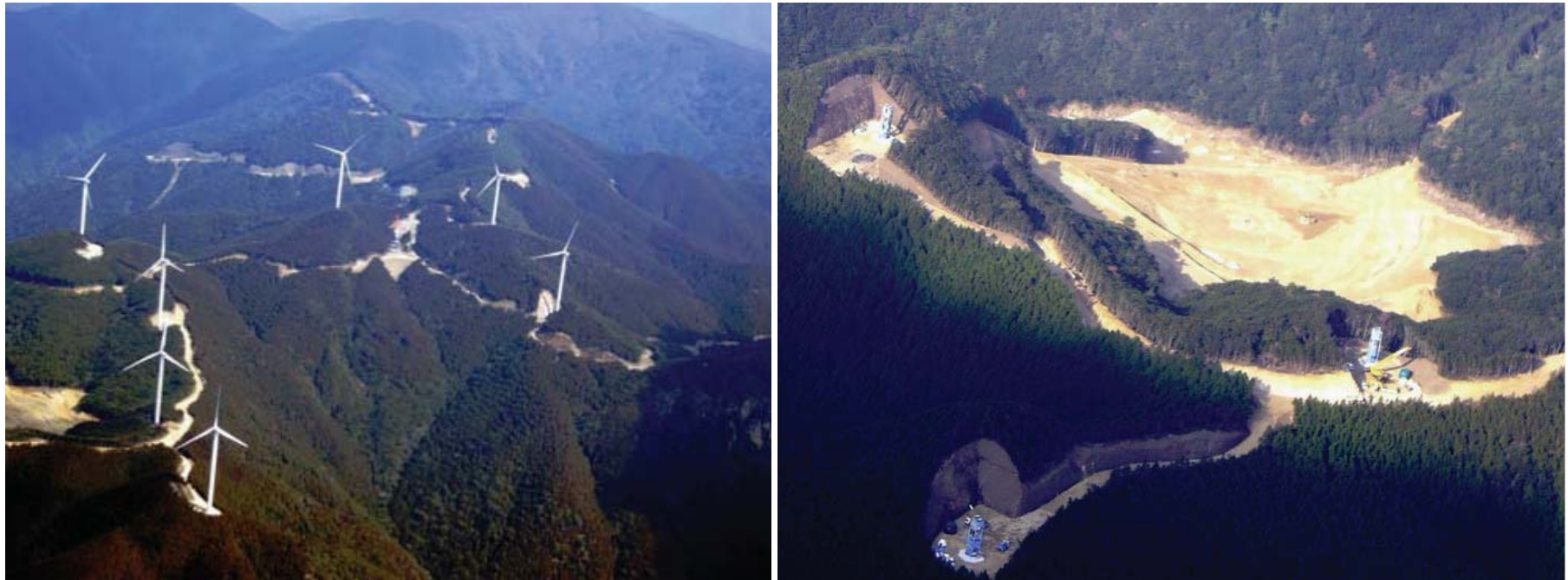
尾根伝いに風力発電所の付設及び取付道路の建設による土地改変の例
