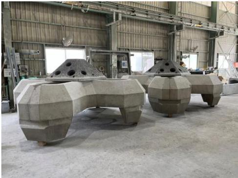
本藻場造成構造物1基の製造には、産業副産物を利用した低炭素コンクリートを使用している。
