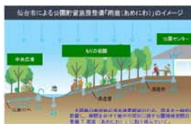
公園貯留施設整備 (名取川水系、仙台市)
