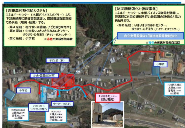
図2 木質バイオマスエネルギーを利用した地域熱供給システムと自立発電設備
