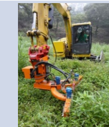
林業における下刈り作業軽労化のための下刈りロボット
