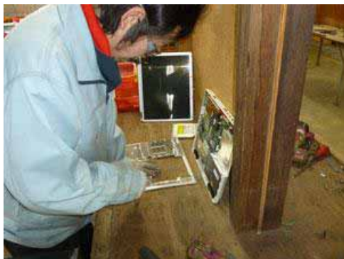
常に使用している作業台で解体作業
