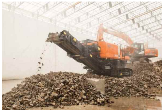
写真 3-5-17 自走式破碎機
