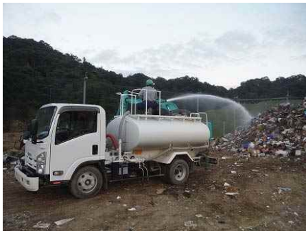
写真 1-2-4 散水車両を活用し洗浄
