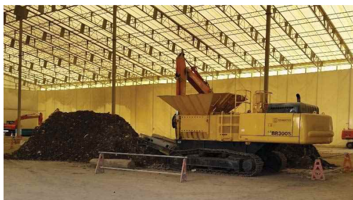
写真 3-5-15 自走式破碎機
