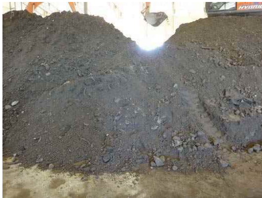
写真 5-2-1 土砂内に紛れ込む劣化した「土のう袋」の切れ端
