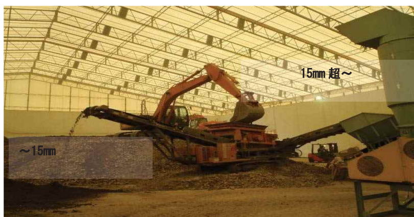
写真 3-5-12 振動スクリーンによる分別
