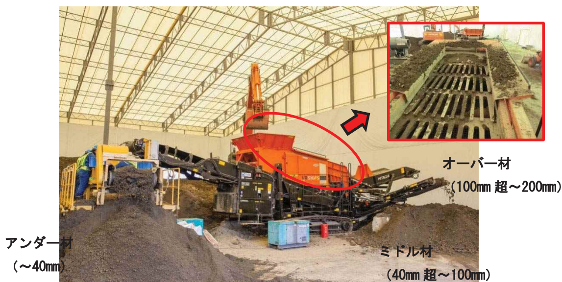
写真 3-5-8 振動スクリーンによる選別
