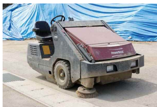
写真 3-5-27 ロードスウィーパー
