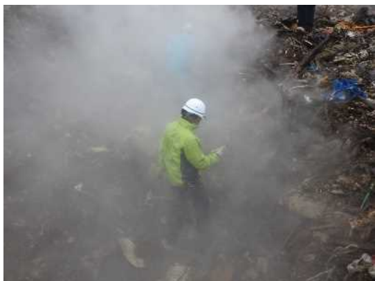
温度上昇により白煙が発生した様子
